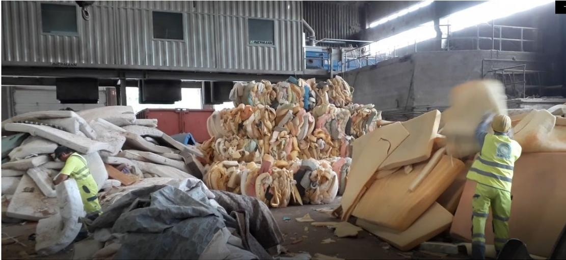
Abb. 6: Aussortieren von Matratzen für die Verwertung von Polyurethan-Schaumstoff (PUR) bei einem Tochterunternehmen von August Meyer Recycling in Osnabrück
