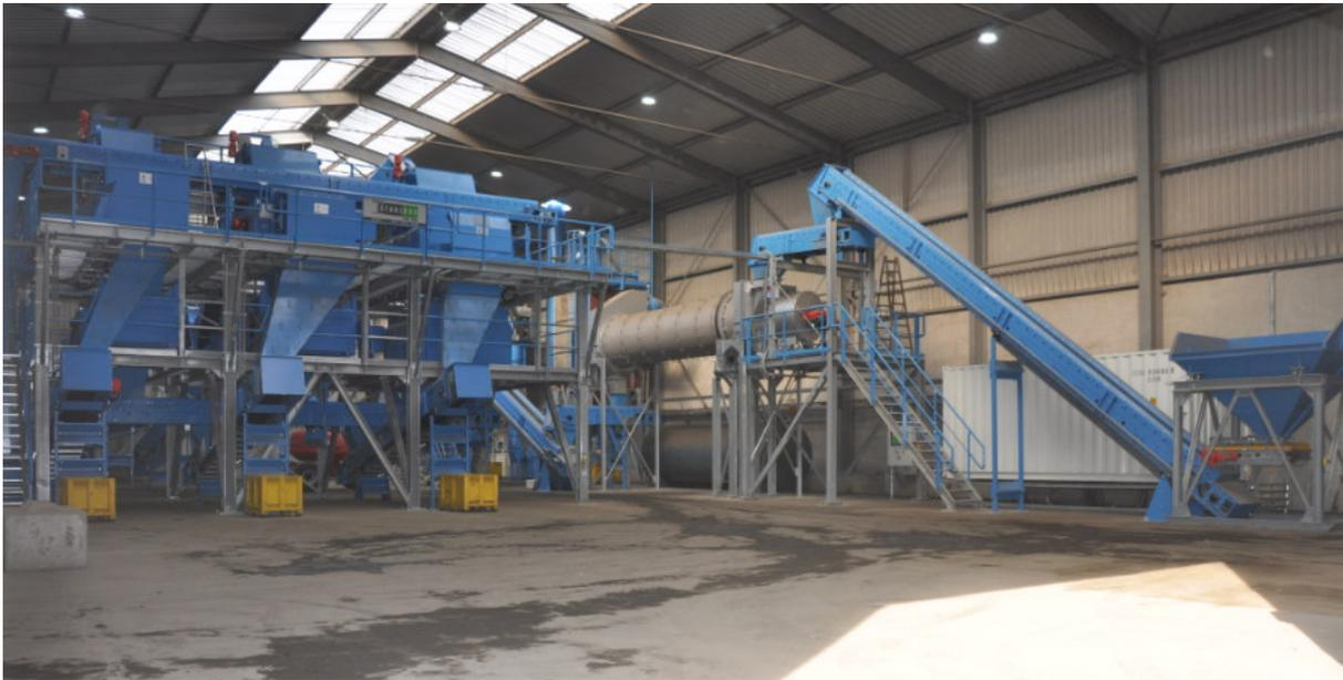
Abb. 6: Teilansicht der STRATEGO-Anlage zur Rückgewinnung von Metallen aus MVA-Schlacken (Foto: CC Umwelt)
